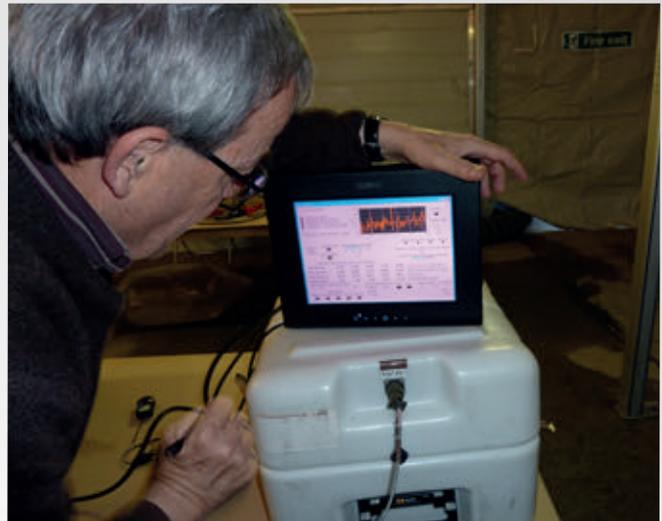
Demostración del uso de un muestreador de gases nobles subsuperficiales durante el tercer ejercicio preparatorio.
