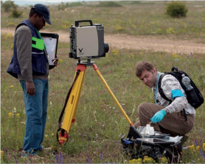
Instalación de un identificador de radionúclidos de germanio de gran pureza durante el tercer ejercicio preparatorio.
