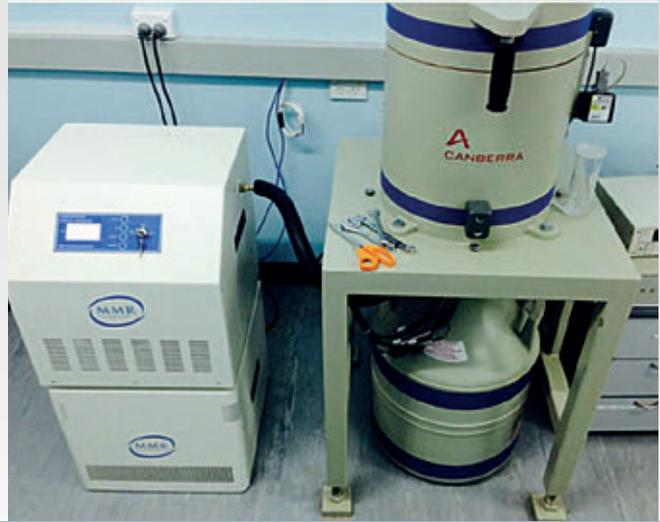
Nuevo generador de nitrógeno líquido, que se instaló en la estación de radionúclidos RN26, Nadi (Fiji).
