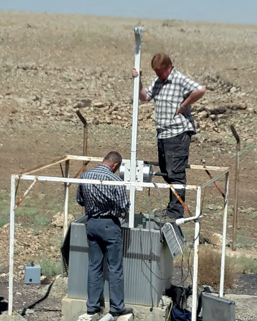
在特尔阿拉斯法辅助地震台站 AS56 安装传感器（约旦）
