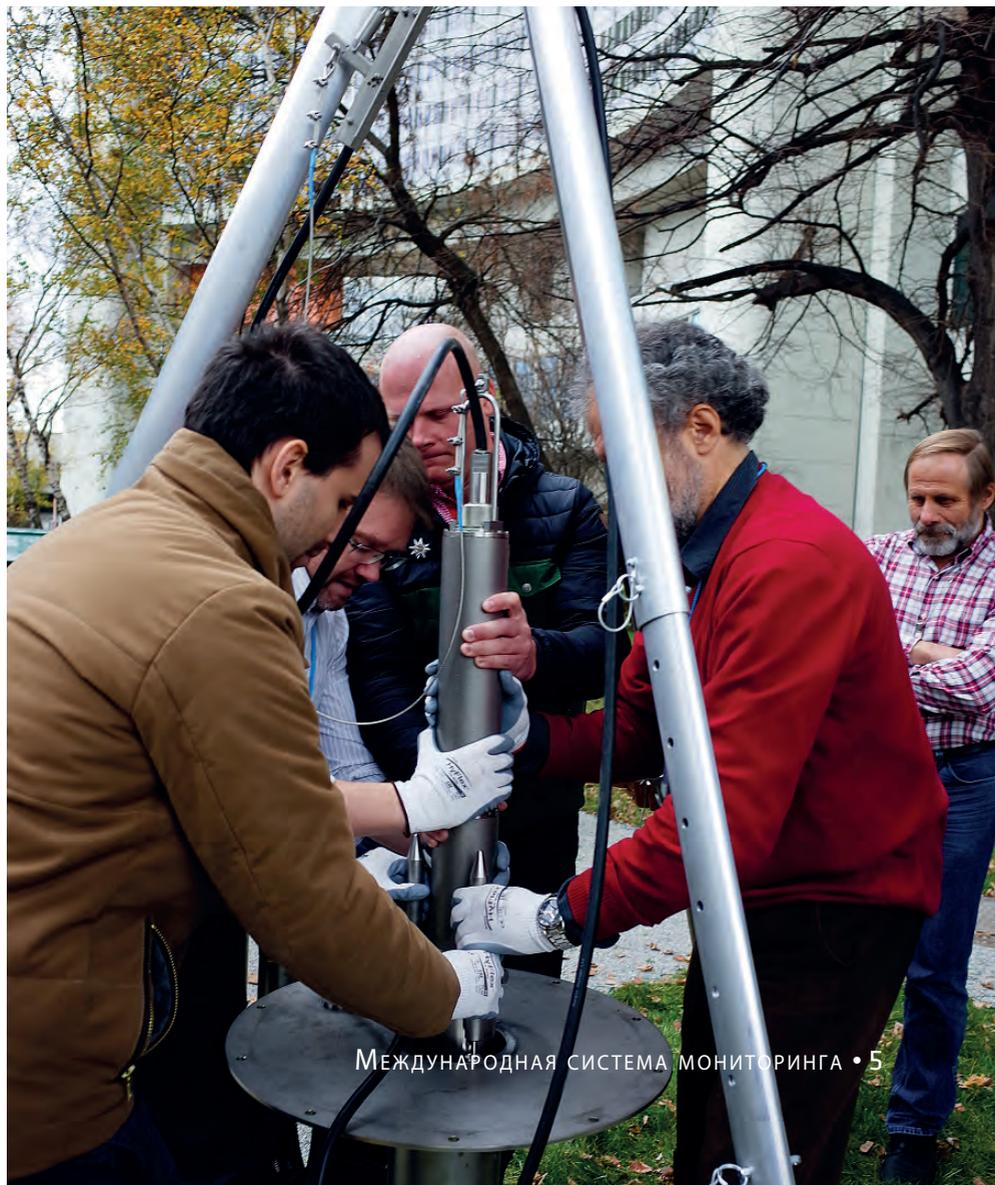
Установка скважинного сейсмического датчика на испытательном объекте Комиссии, Вена
