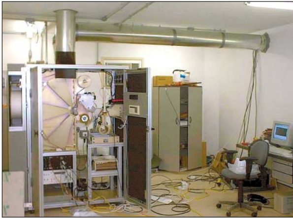
Автоматический воздухозаборник для взятия проб аэрозолей (RASA), установленный на радионуклидной станции RN11, Рио-де-Жанейро, Бразилия.
