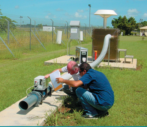
الجهاز اليدوي لأخذ عينات من الهواء وقياس الجسيمات في محطة رصد النويدات المشعة RN28، بوانت آبيتر، غواديلوب، فرنسا.
