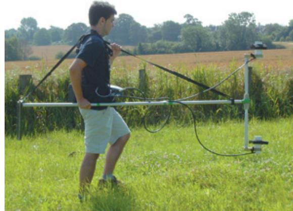
现场视察设备示范，联合王国：借助铯蒸气磁强仪进行磁场测绘调查。
