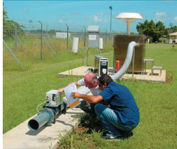
对手动微粒采样器进行气流测量检查，放射性核素台站 RN28，法国，瓜德罗普岛，旁他匹特。
