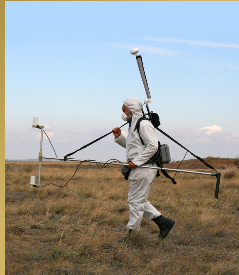
مفتش موقعي مختص يحمل مقياسا للمغناطيسية، وهو أداة تقيس الانحرافات في المجال المغناطيسي للأرض وتساعد على تحديد التجاويف التي قد تكون ناجمة عن انفجار نووي تحت الأرض
